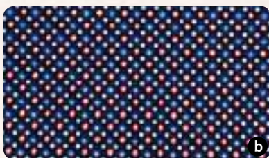
【圖4】此圖拍攝對象為SONY XZ3手機螢幕，照片經過裁切只保留正中央相同位置。圖(a)為直接拍攝；圖(b)則是使用iPad mini倍率放到最大拍攝。
